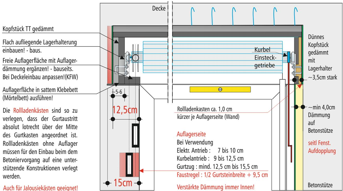
Bei einseitigem Auflager mit 90° Ecklösung mit Aufhängebügel und Stahlstütze. - WDVS - Mauerwerk
