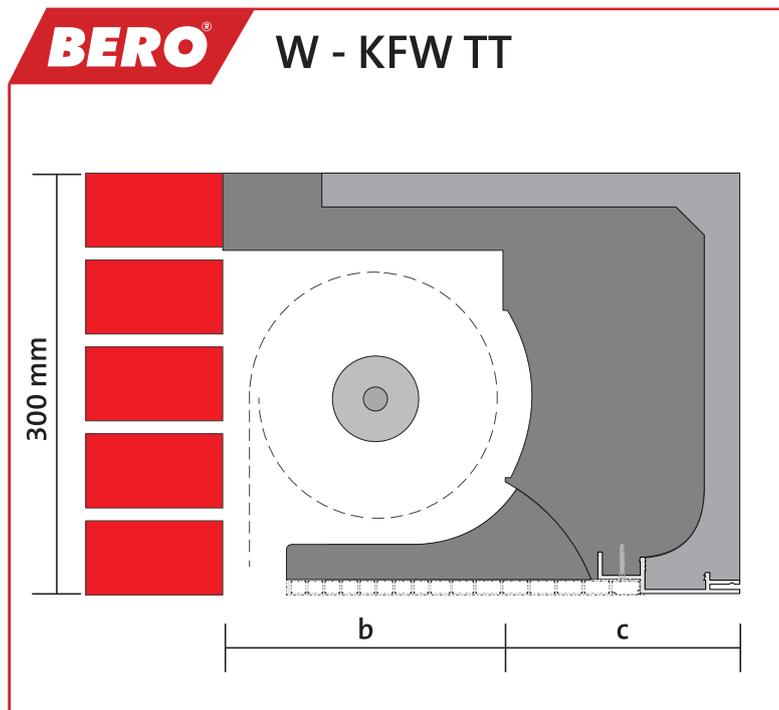
Selbsttragender Rollladenkasten aus bewehrtem BEROpor-Leichtbeton für ein zweischaliges Mauerwerk und einer **inneren Montageöffnung**.
